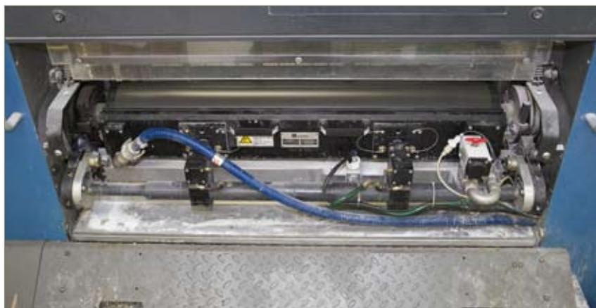
Рис. 3. Растровый вал в лакировальной секции KBA Rapida 105-5-L
