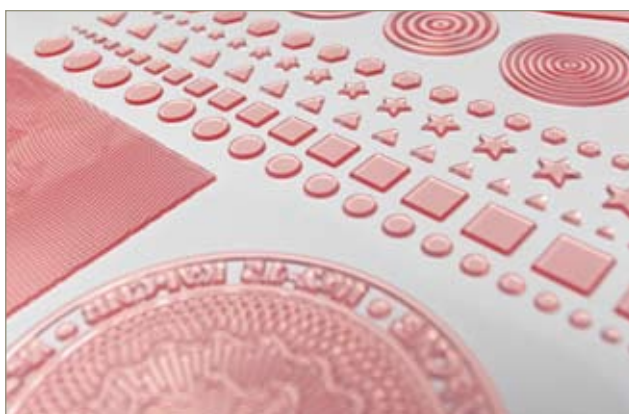
Рис. 5. Фотополимерная форма для технологии 3D Evolution (вверху) и ее фрагмент (внизу)
