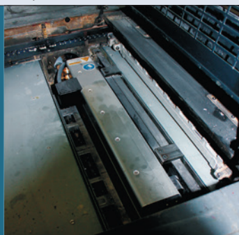
На стареньком Speedmaster ещё можно увидеть следы противоотмарывающего порошка. Но после того как его отчистят, новый уже не появится. Да и печатникам так работать гораздо комфортнее. На фото в центре — смонтированная сушка LED UV XP9. На фото справа — шкафы управления и охлаждения
