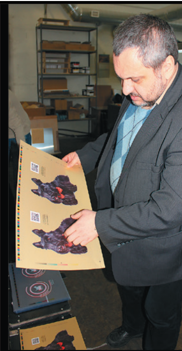
Максим Румянцев проверяет результаты очередного теста — на дизайнерской бумаге с металлизированным эффектом отпечатан фирменный скотч-терьер. СМΥК плюс белила — и всё сухо! На заднем плане — такие же сухие оттиски на пластике
