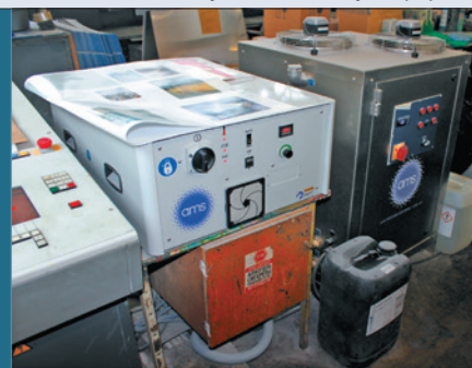
На стареньком Speedmaster ещё можно увидеть следы противоотмарывающего порошка. Но после того как его отчистят, новый уже не появится. Да и печатникам так работать гораздо комфортнее. На фото в центре — смонтированная сушка LED UV XP9. На фото справа — шкафы управления и охлаждения
