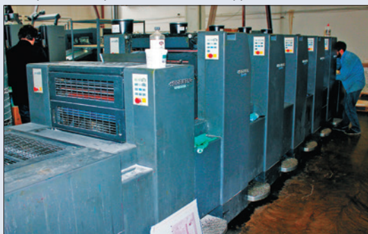
На стареньком Speedmaster ещё можно увидеть следы противоотмарывающего порошка. Но после того как его отчистят, новый уже не появится. Да и печатникам так работать гораздо комфортнее. На фото в центре — смонтированная сушка LED UV XP9. На фото справа — шкафы управления и охлаждения
