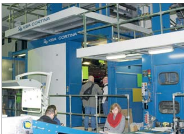
Рулонная газетная печатная машина KBA Cortina в типографии Einbecker Morgenpost в городе Einbeck
