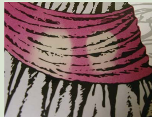
Пример использования пурпурной краски с термохромным эффектом. Пятна на ней — не дефект печати, а результат прикосновения пальцев к оттиску. Через несколько минут пятна исчезнут
