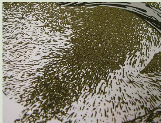
Лак, имитирующий бронзирование. Создает ощущение, что на оттиск нанесен бронзовый порошок. В данном примере добавлен еще и рельефный лак
