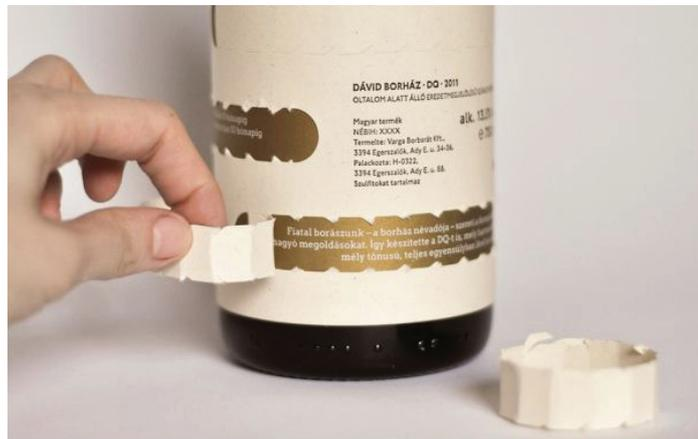
Технология следующая: на обратную, запечатанную сторону этикетки наносится специализированный лак, который при приклеивании этикетки на бутылку не даёт клею проявить все свои адгезионные силы. В результате чего этикетку можно легко отделить и прочитать то, что написано на обороте.
